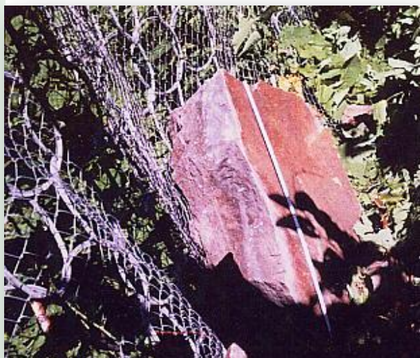
最大落石 (落石: V=1.1 \times 0.8 \times 0.3=0.264\text{m}^3 )
